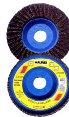
Disco abrasivo lamellare flessibile, diam. mm.178 foro mm.22 grana 60 disco al corindone ossido di alluminio con supporto nylon, per acciai normali, metalli non ferrosi, velocità max.8600 giri/min.
