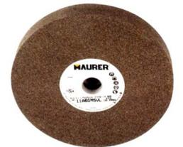
*Mola abrasiva ad impasto ceramico in carburo di silicio verde c49. con elevato potere abrasivo. indicata per la sgrossatura, smerigliatura e finitura di carburi metallici tipo widia e anche per marmi, granito, vetri e cristalli.*
