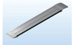
*Struttura per carico/scarico in alluminio estruso ad alta resistenza - superficie con lavorazione a bagnatura antiscivolo - foro centrale per l'ancoraggio al veicolo - gancio zincato con maniglia e coprmaniglia in plastica morbida - richiudibile - portata singola 250kg - portata in coppia 500kg - larghezza 200mm -*
