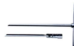
Chiave a "t" snodata per candele usag 278n. bocca esagonale da 16mm, guarnizione in gomma per il trattenimento della candela, asta di manovra scorrevole ed estraibile. lunghezza 270mm. 290gr.
