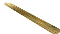
*E' una lega d'apporto per saldobrasatura di impianti in rame, secondo norme din 8513-bs1845-aws a.5.8.81. adatta per rame-rame, rame-ottone, rame-bronzo, non adatta per leghe di ferro, nichel ed impianti gas solforosi, oleodi namica.*
