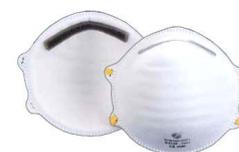
Maschera di protezione ffp1d, con struttura in plastica rigida antischiacciamento anche in condizioni di alta umidità, stringinaso non in metallo ma modellabile, dotata di elastico. la lettera d, indica che la maschera supera il test opzionale dolomite, previsto dalla normativa en149, test in ambiente saturo di polvere di dolomite. la maschera pertanto dura piu' di 8 ore.
