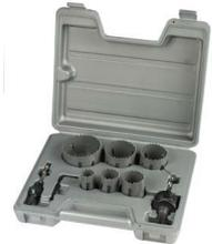
*Seghe a tazza acciaio hss bi-metal, corpo unico e denti a passo variabile. profondita' di taglio 38mm. per forare lamiere, tubi, leghe leggere, metalli legno, compensato e plastiche.*
