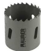
Sega a tazza bimetallica al cobalto 8% aisi m42 a dentatura variabile tagli o professionale e profondo acciaio inox acciai,duri,ghisa,alluminio, bronzo ,ottone,legno duro e derivati,resine sintetiche,laminati plastici, gomma du ra, cartongesso.
