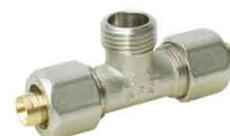
*Il raccordo multistrato a stringere, si presta per ogni tipo di impianti id rotermosanitari, la semplicità d installazione è dovuta all utilizzo di normali chiavi e dalla standardizzazione dei filetti gas iso 228 , inoltre è possibile riutilizzare il raccordo nel caso di errata installazione. nell accoppiamento con altri raccordi non utilizzare canapa bensì un sigillante s*
