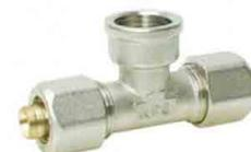
*Il raccordo multistrato a stringere, si presta per ogni tipo di impianti id rotermosanitari, la semplicità d installazione è dovuta all utilizzo di normali chiavi e dalla standardizzazione dei filetti gas iso 228 , inoltre è possibile riutilizzare il raccordo nel caso di errata installazione. nell accoppiamento con altri raccordi non utilizzare canapa bensì un sigillante s*
