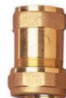
*Tubofix e' un raccordo rapido scorrevole per impianti in tubo di ferro. consente di riparare e modificare gli impianti senza la necessita' di effettuare filettature in opera. la tenuta meccanica dell'accoppiamento con il tubo, e' garantita dall'anello conico inox che incide, graffiando l'acciaio del tubo.*
