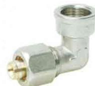
*Il raccordo multistrato a stringere, si presta per ogni tipo di impianti idrotermosanitari, la semplicità d'installazione è dovuta all'utilizzo di normali chiavi e dalla standardizzazione dei filetti gas iso 228, inoltre è possibile riutilizzare il raccordo nel caso di errata installazione. nell'accoppiamento con altri raccordi non utilizzare canapa bensì un sigillante s*
