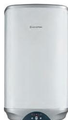
Scaldacqua elettrico murale ad accumulo, display soft touch, programmazione giornaliera, alta precisione di regolazione grazie alla sonda ntc, anodo di magnesio di elevate dimensioni, valvola di sicurezza testata a 8 bar, calda ia smaltata al titanio a 850°C. e' programmabile e permette un risparmio en ergetico fino al 20%.
