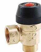
La valvola di sicurezza con apertura manuale a volantino light , è una valvola automatica predisposta per aprirsi qualora la pressione interna dell'impianto raggiunga il limite massimo prefissato pressione nominale di taratura a pnr , permettendo all'acqua di sfogarsi attraverso di essa. la valvola di sicurezza si ripristina automaticamente quando la pressione interna
