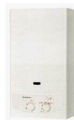
*Scaldabagno a gas istantaneo a camera stagna - potenza termica max/min 27,3/12kw - potenza termica utile max/min 24/8,9kw - peso 16kg - portata specifica acqua sanit. a 25°C 14 l/min - tensione/freq. alimentaz. v/hz 230/50 misure lxxp 330x595x230mm. - entrata acqua fredda 3/4" - ingresso gas 3/4" - uscita acqua calda 1/2" - gas metano g/c*
