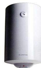
Scaldacqua elettrico murale ad accumulo - installazione multi posizione h/v - funzione eco - caldaie smaltate al titanio a 850°C - doppio anodo di magnesio e doppia flangia a 5 bulloni - valvola di sicurezza 8bar - display led - cavo c/spina shuko - potenza 1,5kw - ipx4 - temp.max d'esercizio 80°C - volt 230 peso 20kg - dim. a,l,p, 800x490x270mm -garanzia 5 anni
