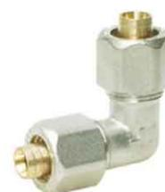
*Il raccordo multistrato a stringere, si presta per ogni tipo di impianti idrotermosanitari, la semplicità d'installazione è dovuta all'utilizzo di normali chiavi e dalla standardizzazione dei filetti gas iso 228, inoltre è possibile riutilizzare il raccordo nel caso di errata installazione. nell'accoppiamento con altri raccordi non utilizzare canapa bensì un sigillante s*
