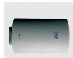
Scaldacqua elettrico murale ad accumulo - caldaia in acciaio smaltato, testata a pressione di 16 bar. coibentazione in poliuretano espanso zero cfc. regolazione esterna temperatura da 40°C a 75°C tranne per 150 e 200lt. anodo di magnesio intercambiabile. resistenza corazzata.
