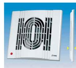
Standardmatic Ø100 aspiratore assiale con serranda automatica, applicazione a muro, soffitto, pannello. indicato per ambienti e bagni di piccole dimensioni. la serranda automatica evita i rientri d'aria ad aspiratore spento. w.21 foro Ø100 portata 95 mc/h. dimensioni mm.154x154 peso kg.0,70
