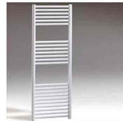
*Radiatore in acciaio colore cromo lucido, montanti verticali di spessore 1.5 mm - tubi orizzontali di spessore 1.2 mm e diametro 25 mm. fornito con 3 attacchi da 1/2" e uno cieco. avvolto in film termoretraibile e quindi imballato in scatola di cartone insieme con mensole e valvolina di sfiato da 1/2" - pressione max 8 bar - temperatura max esercizio 95°.*
