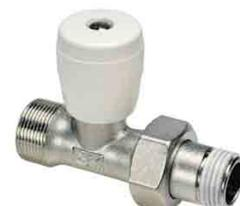
*Detentore sabbiato dritto, attacco intercambiabile per tubo rame e polietilene, codolo a tenuta o.ring 3/8" m*
