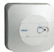
Scaldacqua elettrico ad accumulo - caldaia in acciaio smaltato, testata a pressione di 16 bar. coibentazione in poliuretano espanso zero cfc. regolazione esterna temperatura da 40°C a 80°C. anodo di magnesio. termostato dotato di sistema tbst per garantire maggiori prestazioni. spia funziona
