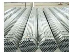
*Tubo saldato laminato a freddo, e zincato a caldo a norma en 10255 sl1, con estremità filettate piu' manicotto - barre da mt. 3 - diam.1/2" spess.2,3 - peso kg 3,51 circa*
