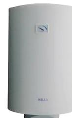
Scaldacqua elettrico murale ad accumulo - caldaia in acciaio smaltato, testata a pressione di 16 bar. coibentazione in poliuretano espanso zero cfc. anodo di magnesio intercambiabile.
