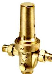
Il riduttore di pressione a pistone pn 25 con codoli maschio è una valvola automatica che riduce e stabilizza la pressione di un fluido all'interno di una condotta di distribuzione in base al valore preimpostato. L'impiego di tale dispositivo idraulico si rende necessario se la pressione massima possibile in qualunque punto del sistema di approvvigionamento di acqua può raggiungere o ecc
