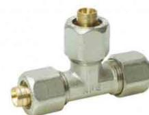
*Il raccordo multistrato a stringere, si presta per ogni tipo di impianti id rotermosanitari, la semplicità d installazione è dovuta all utilizzo di normali chiavi e dalla standardizzazione dei filetti gas iso 228 , inoltre è possibile riutilizzare il raccordo nel caso di errata installazione. nell accoppiamento con altri raccordi non utilizzare canapa bensì un sigillante s*
