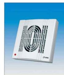
Ventil 10 aspiratore assiale con apertura manuale della serranda, applicazione a vetro o pannello con spessori da 2 a 5 mm. griglia esterna antipioggia, indicata ambienti di piccole dimensioni w.20 foro Ø135 portata 68 mc/h dimensioni mm.154x154 peso kg. 0,9
