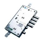
Doppia serratura doppia mappa con chiusura entrata chiave serratura super. serr.super.triplice a 4 mand.con mezzo giro Ø20 azionato da chiave e quadro maniglia quadro 8 - serratura inferiore laterale a 2 mandate - dotazione 3 chiavi dm art.92187 x serr.super. 3 chiavi dm art.92187 x serr. inferiore2 mostrine interne art.95324 2 mostrine esterne art.95323
