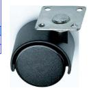
Supporto a cuffia sferica roll-star in acciaio stampato rotante su doppia c orona di sfere, esecuzione cromato, l'impiego e' consigliato per mobili ed attrezzature per ufficio, espositori, arredamenti metallici, carrelli, polt rone, ecc. attacco piastra girevole mm.40x40 ruota in gomma nera Ø 30 porta ta indicativa kg. 20
