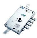
Serrature dipendenti con blocco serratura superiore - triplice x doppio cil indro - variazione interassi mm.28/37 - serratura superiore con mezzo giro Ø20 azionato da cilindro superiore e inferiore e maniglia quadro 8 entrata cilindro e maniglia mm.63 - serratura inferiore con chiusura laterale e blo cco serratura superiore -
