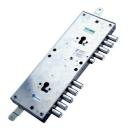
Serratura triplice con mezzo giro per cilindro - variazione interassi 28/37 mm - mezzo giro Ø20 azionato da cilindro e maniglia quadro 8 - entrata cili ndro e maniglia mm63 - corsa chiavistello mm30 a 4 catenacci tondi Ø18, per interasse 28 - corsa chiavistello mm30 a 5 catenacci tondi Ø18, per intera sse 37 - corse aste mm20 -
