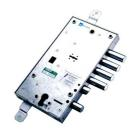
Serratura superiore triplice a 4 mandate con mezzo giro Ø20.entrata chiave e maniglia mm63.serratura inferiore laterale a 4 mandate con chiusura entra ta chiave della serratura superiore.chiavistelli tondi Ø18 con corsa mm40. corsa aste mm20.dotazione 3 chiavi doppia mappa mm40 serr.sup. 3 chiavi doppia mappa serr.inf. 2 mostrine int 2 mostrine est.
