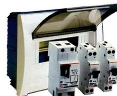
*Interruttore automatico magnetotermico 1p+n 10a serie din2058, con vetrino porta cartellino, 4,5ka, tensione 230v, corrente nominale 10a, potere di interruzione di servizio 4500a, potenza dissipata 2,8w, colore grigio ral 703 5, ip20, 35x83x58mm, 2 moduli, sezione cavo 25/35.*
