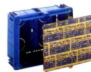
*Cassetta stagno ip65 - coperchio grigio a pressione - guarnizioni e passaca vi costampati - pareti lisce e coperchio a filo permettono il montaggio di più scatole affiancate - 12 entrate stagne pretranciate di diametro variabili da pg9 a pg21 permettono la connessione di tubi e cavi in modo rapido e senza l'utilizzo di alcun strumento - g/a*
