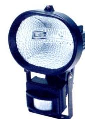
*Proiettore da esterno adatto all'illuminazione di piccole, medie e grandi aree - corpo in alluminio pressofuso - staffa portafaro in acciaio verniciato - a tenuta stagna - vetro temperato resistente agli shock termici - alimentatore 230v 50hz - peso 5,250kg - dimens l,h,p, 255x390x120mm - ip55 - lampada attacco rx7s md 150w lineare a doppio attacco g/c*
