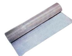
*Zanzariera di alluminio con maglia da 18x14 con filo di diametro nominale 0,23-0,25mm, peso del tessuto nominale gr/mq 140-175, tipo di rivestimento e possidico, colore grigio, in rotolo da 30mt.*
