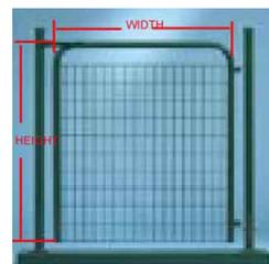
Cancello pedonale colore verde, 2 pali con diametro di 60mm o 76 a seconda dell'altezza, telaio 40x40mm, rete maglia ondulata 50x50mm, maniglia in plastica e battente in ferro, serratura standard europeo con chiavi. peso 24kg.
