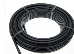
*Tube di polietilene alta densita' pe80 per fluidi in pressione secondo la norma UNI 10910, per fluidi in pressione con temperatura fino a 40°, adatti sia al convogliamento di fluidi alimentari e di acqua potabile. con temperatura di 20° sopporta pressioni massime di 8bar, a 30° ->6,9bar, a ->40° 5,9 bar. spessore 1,6mm*
