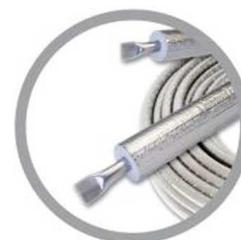
*Tube di classe 1 per uso sanitario e riscaldamento a 5 strati per il trasporto di fluidi alimentari e acqua potabile - max 10bar - temp. max 95°c - po t.term. 0,43 w/m-k - coeffic.dilatazione termica 0,026mm/m-k - rugosità int 0,007mm - raggio minimo di curvatura a mano 5xde/ con utensile 3,5/4,5xde - diam.int.12mm - diam.est.16mm - spessore 2mm - g/c*
