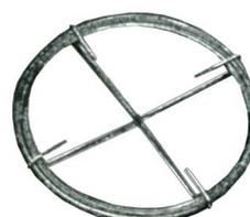
*Fune a trefoli in acciaio zincato con 42 fili 6x7 ppc, diametro fune 1,8mm, peso x 100metri 1,16kg, carico di rottura 231kg, misura esterna rotolo 11,5 cm, peso 1,16kg. resistenza unitaria dei fili 180kg/mm2.*
