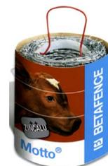
La corda spinosa "spinetto" é composta di due fili portanti a zincatura ord inaria e a basso contenuto di carbonio di mm 1.70 contorti alternativamente e sui quali sono disposti, ad intervalli regolari di cm 10, ricci a quattr o punte di mm 1.50
