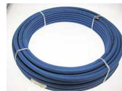
*Tube rame in guaina anticondensa per gas freon, per impianti split e pompe di calore. rispondente alla normativa en12735-1 e uni 5649/71. tubo lavato internamente e subito tappato per preservarne la pulizia rivestito con guai di polietilene bianca, atossica, inodore e esente da clorofluorocarburi. spessore tubo rame 0,80-1mm, guaina 6,5-10mm.*
