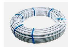
*Tube delatall rivestito per riscald. e distribuzione sanitaria - il tubo multistrato è rivestito con guaina in polietilene espanso a cellule chiuse a bassa densità, rifinito con una pellicola esterna estrusa costituita da polietilene a bassa densità - classe 1 resistenza al fuoco - misure diam.int.12 mm - diam.est.16mm/diam.est.c/isol.28mm - spess.2mm spess.c/isol.6mm -*
