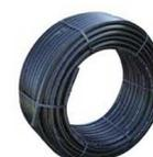
*Tubo polietilene pn16 nero, alta densita' per condotte di fluidi in pressione destinato al convogliamento di fluidi alimentari, di liquidi non alimentari e di acqua potabile. diametro esterno mm.20 spessore mm.1,9 marchio iip-uni . "pe100"*
