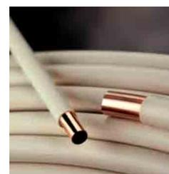
*Tube di rame rivestito con guaina isolante. rame cu-dhp rispondente alla normativa en1057 e conforme alla uni5694/71. rivestimento con guaina in polietilene espanso a cellule chiuse a bassa densità rifinita con pellicola esterna estrusa di superficie goffrata. per impianti di riscaldamento e idrotermosanitari in genere.*
