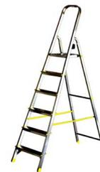
Scala professionale in alluminio 6 gradini. gradino largo mm 83, dimensione chiusa cm 213x51x10, peso kg 6,50, portata kg 150
