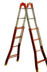
*Scala telescopica in alluminio, elettrosaldata, mod.media, gradini 4+4 lunghezza in posizione verticale cm.380, in posizione a portafoglio libretto cm .192 in posizione chiusa cm.114 ingombro 114x17,5x54 volume mc. 0,085 normativa in 131 peso kg.9 portata kg 150*
